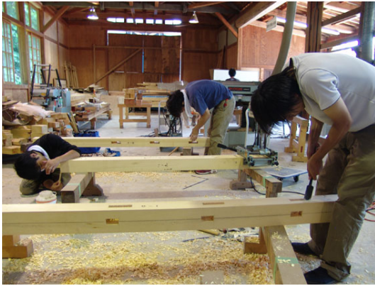
柱加工（建築大工コース）
